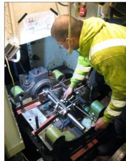
Arbörning av axellager i trycklagerenheten.
