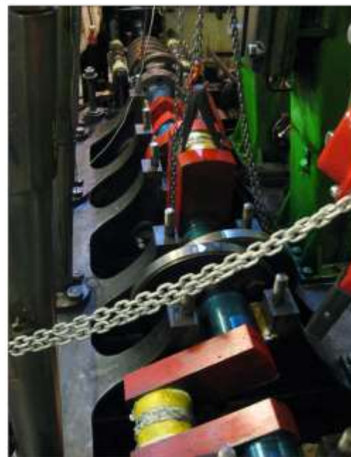
Vevaxeln sedd förifrån med trycklageraxeln längst bort.
